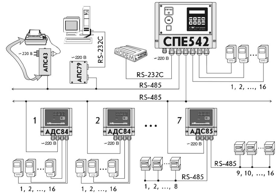
Рисунок 3.3 - Система учета электрической энергии на базе сумматора СПЕ542 с применением адаптеров АДС84 и АДС85
