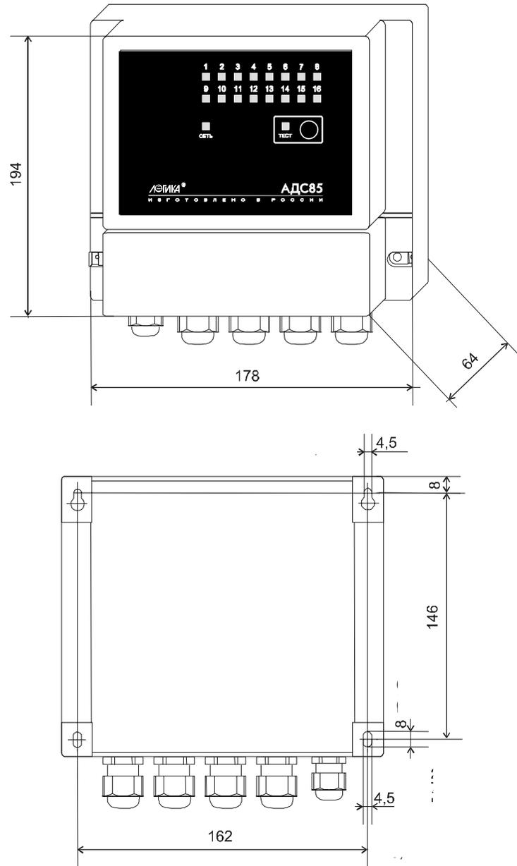
Рисунок 3.1 - Общий вид и вид сзади адаптера АДС85
