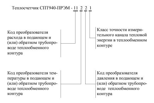
Рисунок 2.1 — Структура обозначения теплосчетчиков
