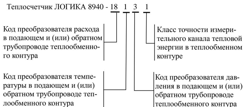
Рисунок 2.1 – Структура обозначения теплосчетчиков
